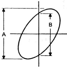
**Fig. 16 Phase shift calculation**
